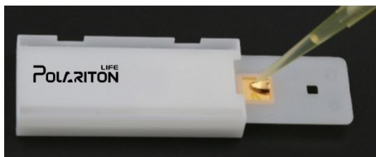
图 25 在芯片内片金膜表面滴加缓冲液
