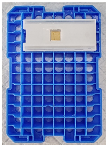
图 2. 用于装载紫外处理光敏芯片的托盘（基于 CM5 外壳改造）
